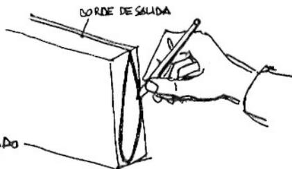
AHORA QUEDA UN BUEN TRABAJO DE CEPILLO Y RASPA HASTA DEJAR TODO DESBASTADO TENIENDO ESPECIAL CUIDADO EN LOS BORTES DE ATAQUE, SALIDA Y PUNTA PARA QUE EL ROZAMIENTO AERODINAMICO SEA MINIMO.
