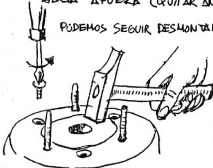
QUITAMOS LOS TORNILLOS QUE LO SUJETAN CON UN DESTORNILLADOR DE CRUCETA Y SE LE DAN GOLPES AL EJE
